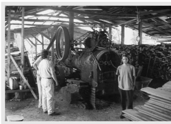
Figura 2: Un locomóvil, marca Garrett , movilizando una sierra en plena ciudad de Gorbea, febrero de 1999, visto junto con el ex-Alcalde de Carahue Ricardo Herrera y el hijo del presente autor. (foto: ithomson)
